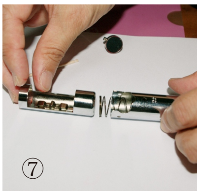
⑦ 下部にスプリングが入って いますので、飛び出さない ように注意して下さい
