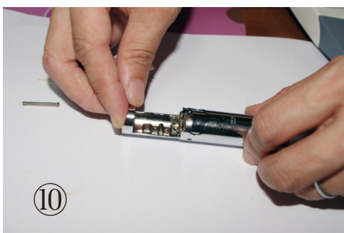
⑩ 印面をかぶせたまま、中筒を外筒に 入れます。向きに注意して下さい
