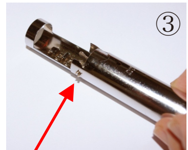
③ この部分をやっこペンチで ピンがぬけるくらいに軽く平に つぶします。重要ポイントです 強くつぶすと後でひらかなく なってしまいます
